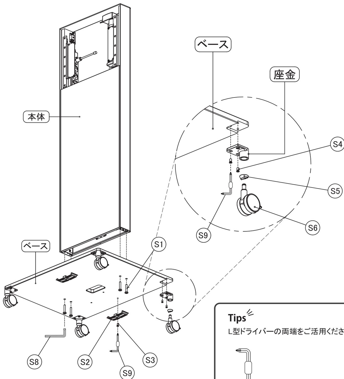
※(S3)十字穴付きJねじ小、(S4)十字穴付き皿ねじ小は、(S9)L型ドライバーで右図のように取り付けます。
