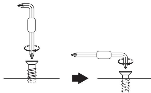
ねじの取り付け始めは、(S9)L型ドライバーを縦方向で使用し、ねじを固定する際は(S9)L型ドライバーを横方向にすることで、力が入りやすくなります。
