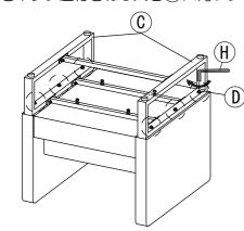
次に、② 貫パイプ(上)の② 六角穴付きボタン座付きねじ大を⑪ 六角レンチで締め付けてください。
