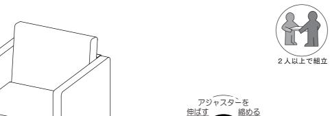
床に接地していないアジャスター を回して水平になるように調整し、 がたつかないようにしてください。
