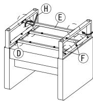
2人以上で本体を起こし、図のように、座クッションを前合わせにし、(B)背クッションを差し入れてください。 その後、傾斜のない場所に設置し、床と座面が水平になるように、アジャスターを調整してください。
