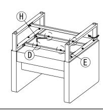
最後に (E) 貫パイプ(上) と (F) 貫パイプ(下) の (G) 六角穴付きボタン座付きねじ小を (H) 六角レンチで締め付けてください。 その後 4 5 で締め付けたねじに緩みがないか確認してください。
