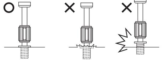
ジョイントシャフトの胴体部分が板面にぴったりと着くまで回し入れてください。それ以上回すと、破損したり上手く組み立てられない恐れがあります。
