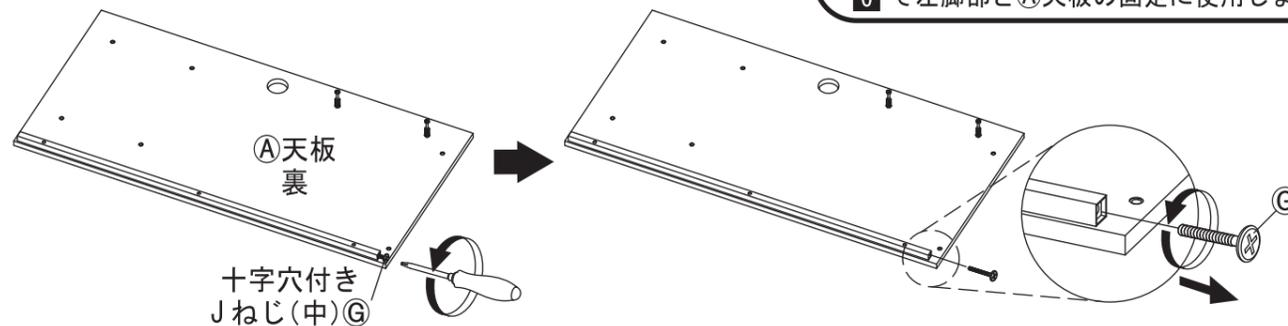
取り外した⑥十字穴付きJねじ(中)は⑥で左脚部と④天板の固定に使用します。
