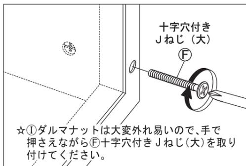
☆①ダルマナットは大変外れ易いので、手で押さえながら⑥十字穴付きJねじ(大)を取り付けてください。
