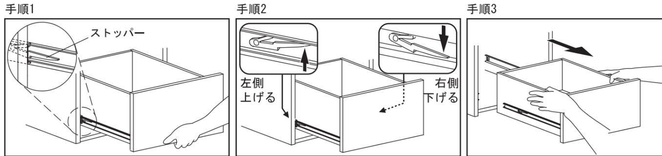
ストッパーが見える所まで引出しを引きます。それ以上無理に引き出すとレールが破損しますのでご注意ください。
