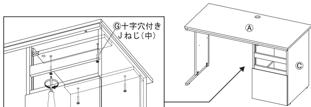
10 ⑩十字穴付きJねじ(中)がしっかりと締め付けられていることを確認したら、引出しを差し込みます。
