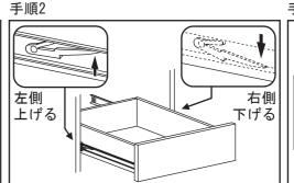
左側のストッパーの先端を上げた状態で、 右側のストッパーの先端を下げながら、 引出を取り出してください。
