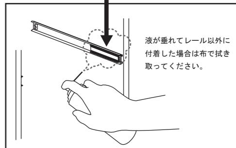
凹凸部分に市販の潤滑スプレー(潤滑剤)を挿します。その後、引出の取り付け方法を参照し、引出を取り付けてから手順1を繰り返してください。
