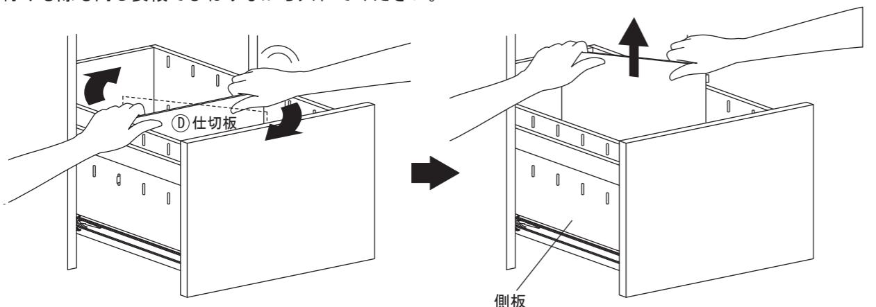
④仕切り板が取り外しにくい場合は、左右の側板を外側に引っ張りながら仕切り板をひねり、取り外してください。
