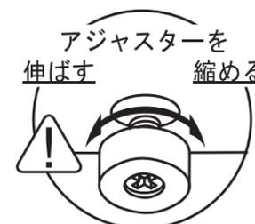
床に接地していないアジャスターを回して水平になるように調整し、がたつかないようにしてください。
