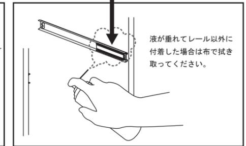
凹凸部分に市販の潤滑スプレー(潤滑剤)を挿します。その後、引出の取り付け方法を参照し、引出を取り付けてから手順1を繰り返してください。
