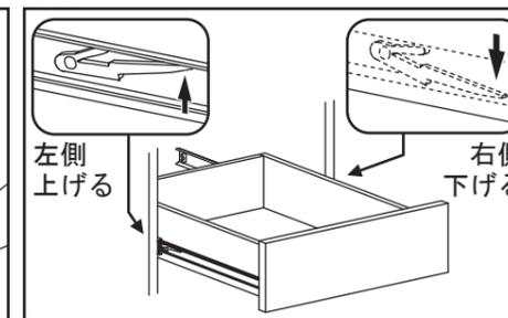
左側のストッパーの先端を上げた状態で、右側のストッパーの先端を下げながら、引出を取り出して下さい。
