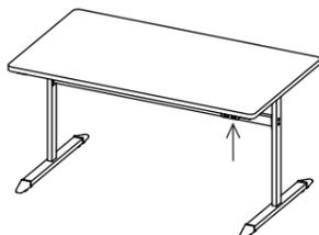
**1** ⑥十字穴付き Jねじ (小) で③補強パイプを①天板に組み付けてください。
