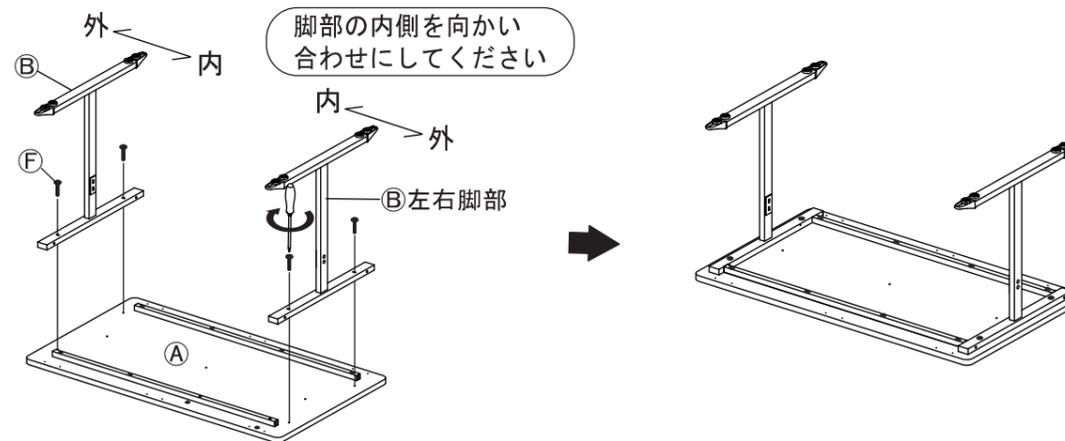
**3** ⑧六角穴付きキャップねじで④貫パイプを②左右脚部に、⑩六角レンチを使って締め付けてください。その後、②で取り付けた⑥十字穴付き Jねじ (小) を全て締め付け直してください。
