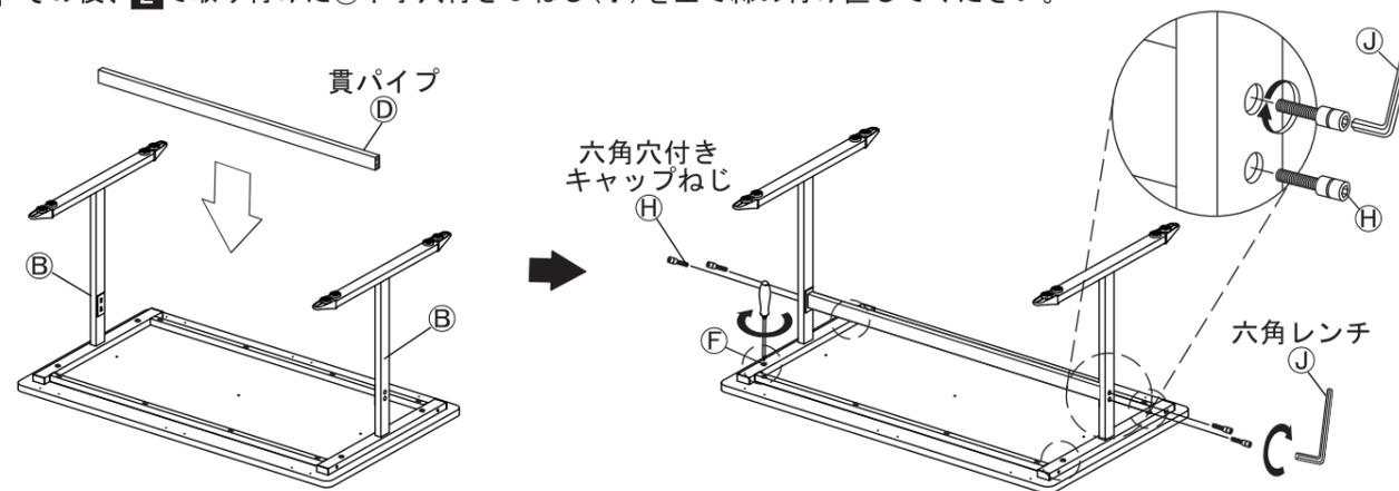
**4** ⑦十字穴付き Jねじ (大) で②左右脚部と③補強パイプを組み付けてください。
