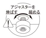
床に接地していないアジャスター を回して水平になるように調整し、 がたつかないようにしてください。
