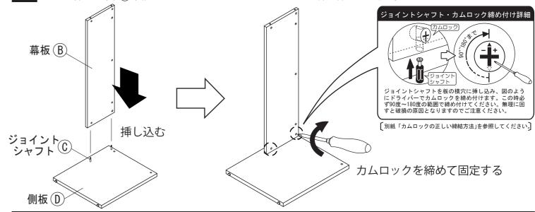
もう一方の®側板を取り付けます。図のように倒し、安定させた状態で®幕板の横穴に®側板に取り付けられた®ジョイントシャフトが入るように挿し込み、®側板のカムロックを締め付けて固定してください。
