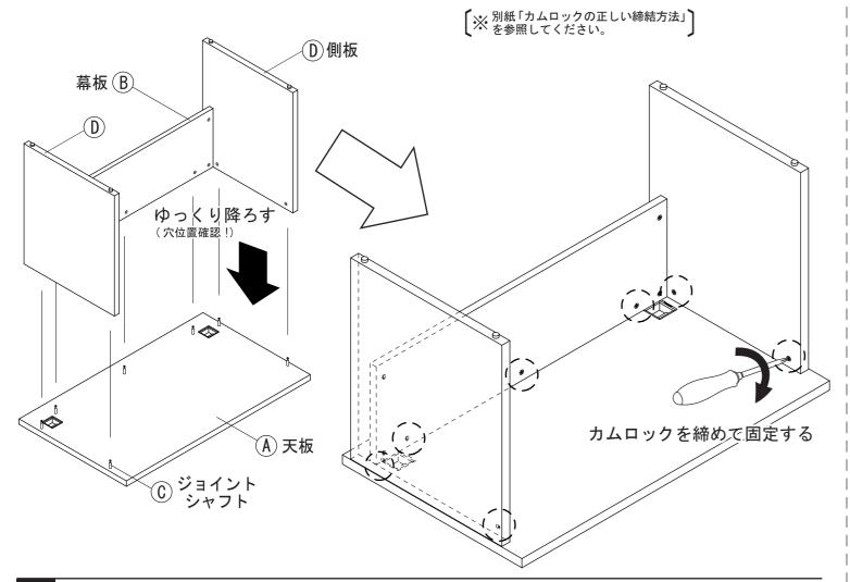
組み立てた商品を2人以上で引き起こします。その後、A)天板の配線穴の蓋に張られている開閉防止テープを 剥がしてからご使用下さい。また、ガタつきや傾きが見られる時は必要に応じて®側板のアジャスターを調整して お使い下さい。
