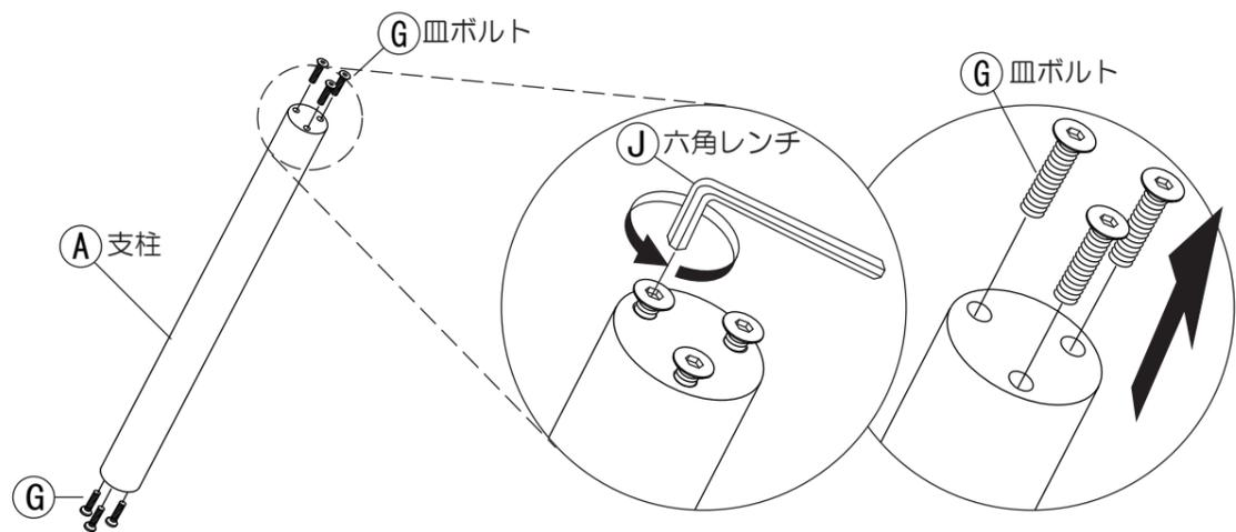
5 (A)支柱に(F)座金を(J)六角レンチを使って(G)皿ボルトでしっかりと取り付けてください。その後、同様にして、(A)支柱のもう一方に(E)ベースを(G)皿ボルトでしっかりと取り付けてください。
