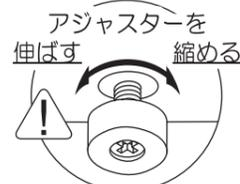
床に接地していないアジャスターを回して水平になるように調整し、がたつかないようにしてください。
