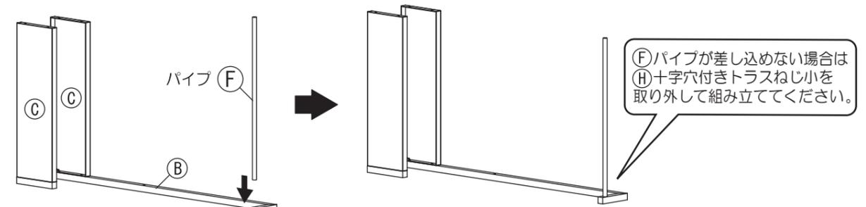
5 ①左脚部をのせ、⑥十字穴付きトラスねじ大でしっかりと固定してください。その後、緩めに取り付けた⑥十字穴付きトラスねじ大をしっかりと増し締めして固定してください。
