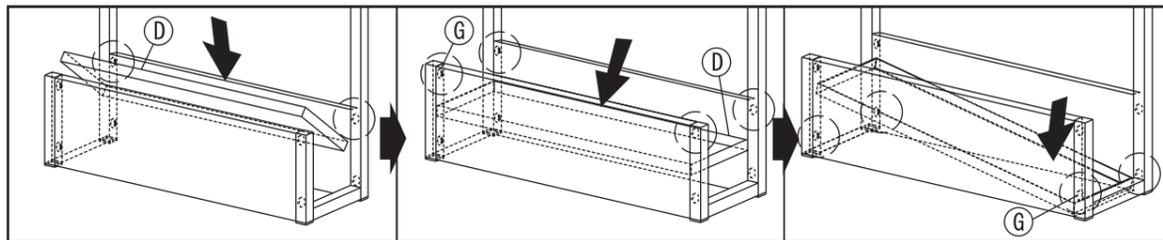
①受皿の長辺を図のように傾けて上の⑥十字穴付きトラスねじをくぐらせてください。
