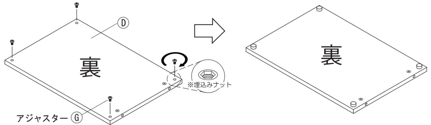
2 ② (A)天板、(C)幕板、(D)底板に、(F)ジョイントシャフトを取り付けます。各部材の埋込みナットに回し入れ、緩みや、付け忘れがないか確認して下さい。また、特に①底板は裏表をお間違えの無いようご注意ください。【別紙「カムロックの正しい締結方法」を参照してください。】
