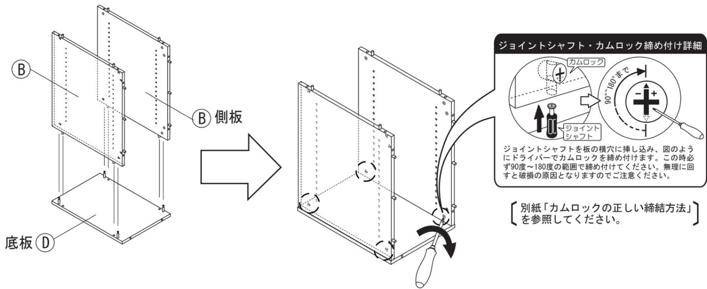
**4** ③幕板を取り付けます。③幕板に取り付けられた⑥ジョイントシャフトが③で組み立てた②側板・④底板の横穴に入るように、また②側板に取り付けられたダボが、③幕板のダボ穴におさまるように挿し込んでください。その後、まず②側板のカムロックを締め付けてください。その状態で③幕板側に倒し、底板の裏面のカムロックも締め付けてください。
