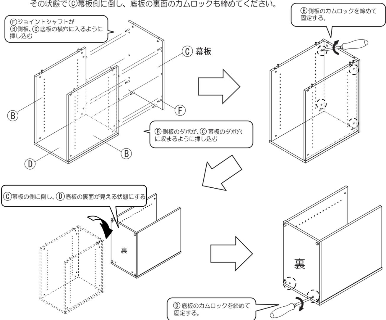
**5** ④で倒した本体を引き起こし、①天板に取り付けられた⑥ジョイントシャフトが②側板、③幕板の横穴に入るように、また②側板のダボが①天板のダボ穴に収まるように挿し込み、カムロックを締め付けて固定してください。
