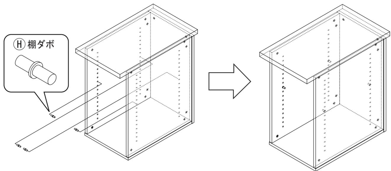
**7** ⑤棚板を⑥で取り付けたい位置に⑧棚ダボの上に乗せて完成です。商品本体にガタつきや傾きがないように、必要に応じて④底板裏面のアジャスターを調整して下さい。
