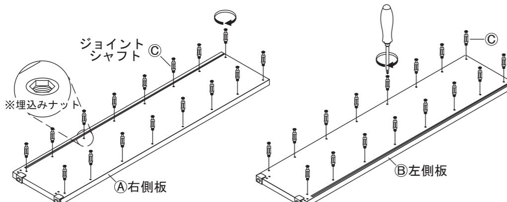
2 ③左側板の最上部に取り付けた④ジョイントシャフトを、⑤天板の横穴に差し込んでください。
