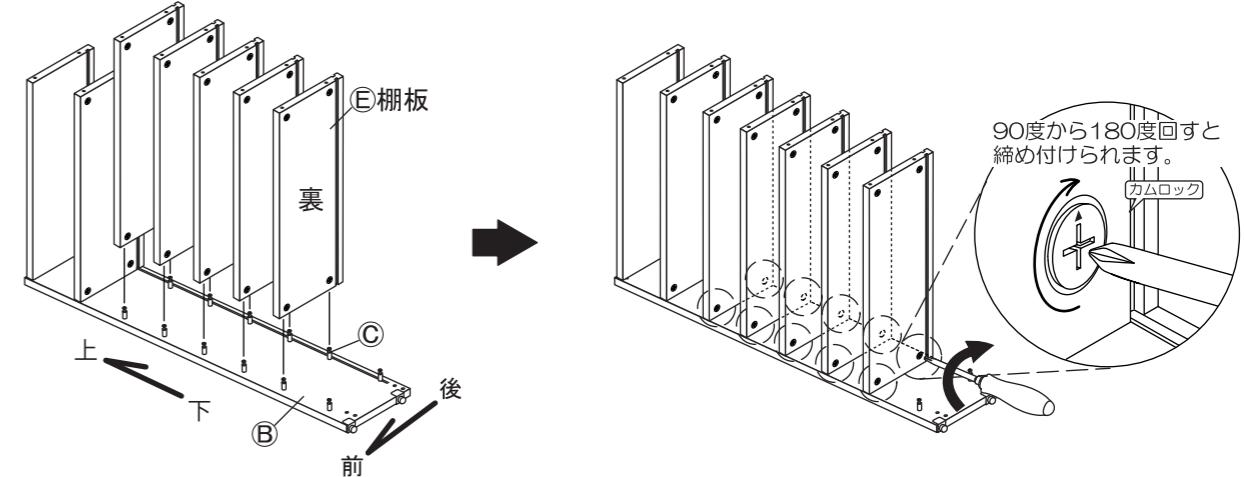
5 ③左側板の④ジョイントシャフトを⑦底板の横穴に差し込みます。
