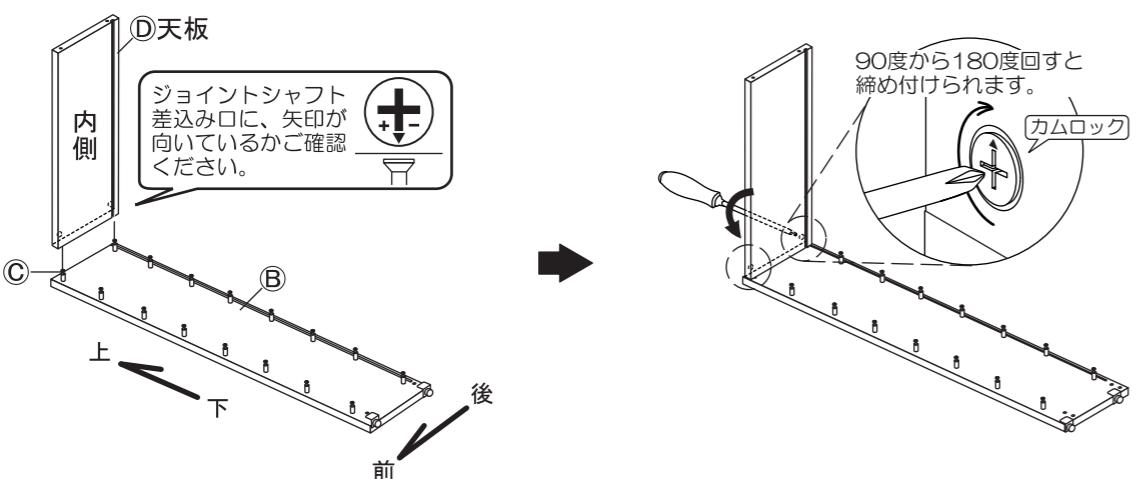
3 ②で取り付けた⑤天板の下に⑥棚板を組み付けていきます。
