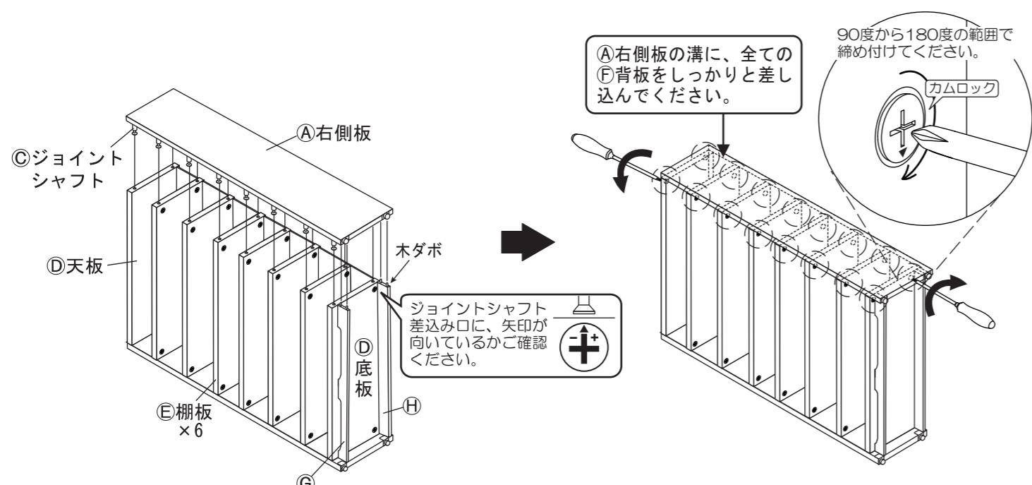
9 最上部・中央・最下部の⑥背板の各4カ所に、①背板止めを差し込み
