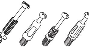
ジョイントシャフトを板面の埋め込み(鬼目)ナットに回し入れます。手で回し入れたあと、プラスドライバーを使用して90度ほど増し締めしてください。
