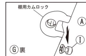
② 図のようにプラスドライバーを差し込み、90度~180度の範囲で締め付けてください
