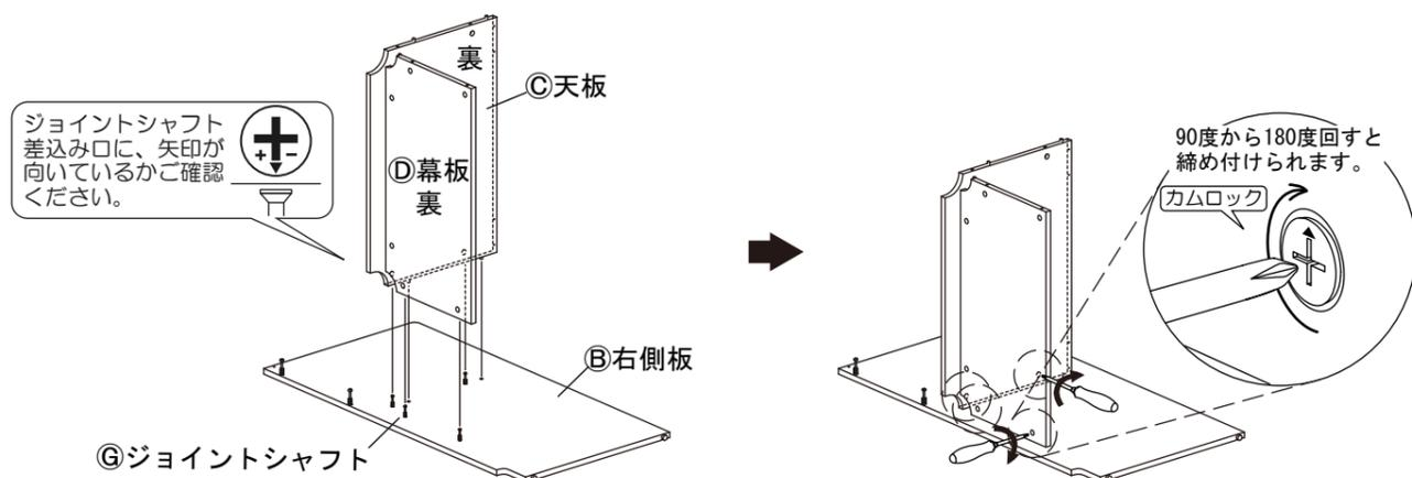
**7** **⑧**右側板の**④**ジョイントシャフトを**3** で組み付けた**⑤**背板・**⑥**貫板の横穴に差し込み、**⑤**背板・**⑥**貫板のカムロックを回して締め付けてください。
