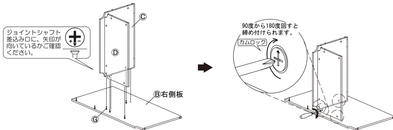
**9** ⑧右側板の④ジョイントシャフトを③で組み付けた⑤背板の横穴に差し込み、
