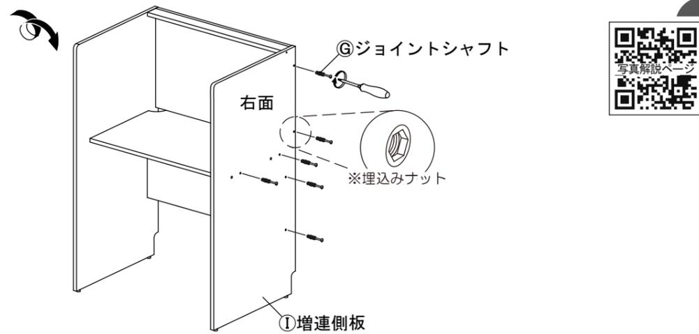
**8** ⑧右側板の④ジョイントシャフトを②で組み付けた③天板・④幕板の横穴に差し込み、
