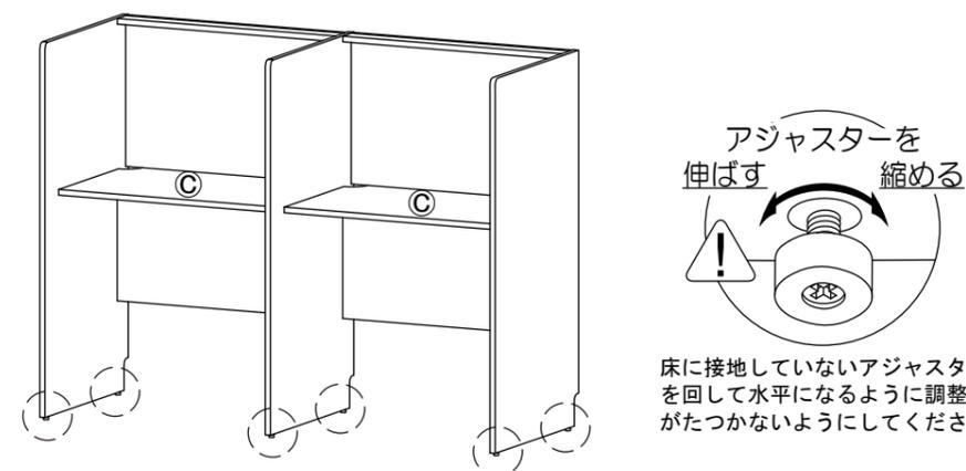
床に接地していないアジャスターを回して水平になるように調整し、がたつかないようにしてください。
