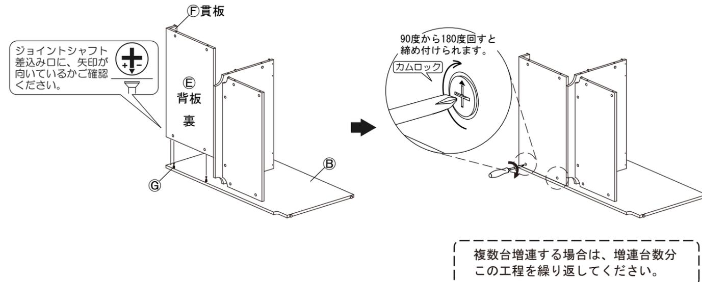
**10** ①増連側板の④ジョイントシャフトを⑨で組み付けた③天板・④幕板・⑤背板の横穴に差し込み、
