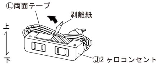
2 ㉢天板の裏面に空いている下穴に合わせ、㉠2ヶロコンセント貼り付けます。その後、㉢十字穴付き皿タッピンねじで㉠2ヶロコンセントを組み付けてください。
