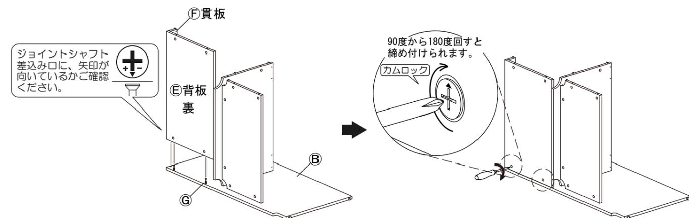
**8** 2人以上で慎重に**5** で組み付けた本体を起こしてください。その後、**①**増連側板の右面に**④**ジョイントシャフトを回し入れてください。※ジョイントシャフト取り付け部分にはナットが埋め込まれています。
