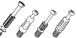
ジョイントシャフトを板面の埋め込み(鬼目)ナットに回し入れます。手で回し入れたあと、プラスドライバーを使用して90度ほど増し締めしてください。
