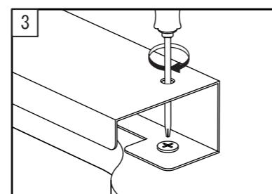
プラスドライバーでⒼ十字穴付き平ねじを増し締めしてください。
