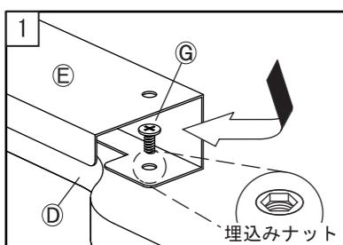
Ⓖ十字穴付き平ねじをⒹ天板の埋め込みナットへ回し入れます。
