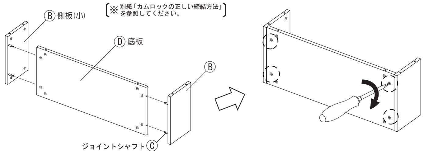
3 2で組んだものに、①側板を取り付けます。①側板に取り付けられた③ジョイントシャフトが②側板(小)および④底板の横穴に入るように設置し、プラスドライバーでカムロックを締めてください。
