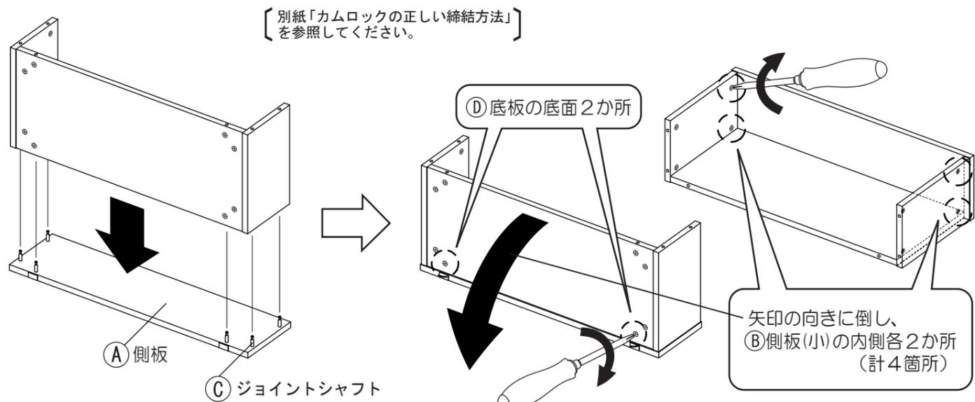
4 反対側の(A)側板も3と同様に、(C)ジョイントシャフトが(B)側板(小)および(D)底板の横穴に入るように設置し、プラスドライバーでカムロック※を締めてください。
