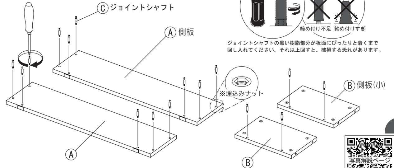
2 ②側板(小)を④底板に固定します。②側板(小)に取り付けた③ジョイントシャフトを④底板の横穴に挿し込み、カムロック※をプラスドライバーで締めて下さい。
