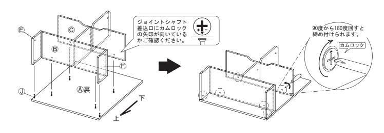
6で組み付けたB天板、©棚板、E側板の横穴に差し込みます。
