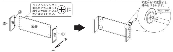
❸天板裏に取り付けた③ジョイントシャフトを、序上仕切板の横穴に差し込みます。 その後、序上仕切板のカムロックを回して締め付けてください。
