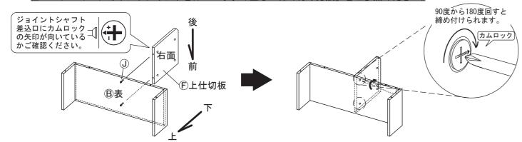
4 ©棚板に取り付けた①ジョイントシャフトを、①下上仕切板の横穴に差し込みます。 その後、①上仕切板のカムロックを回して締め付けてください。
