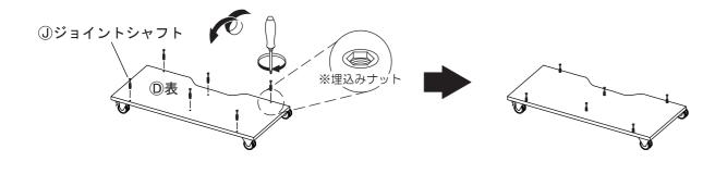
☑で組み付けた本体を、下図のように2人以上で慎重に上下逆さに立てます。 ①底板に取り付けた①ジョイントシャフトをA前板、③下仕切板の横穴に差し込みます。 その後、A前板、G下仕切板のカムロックを回して締め付けてください。
