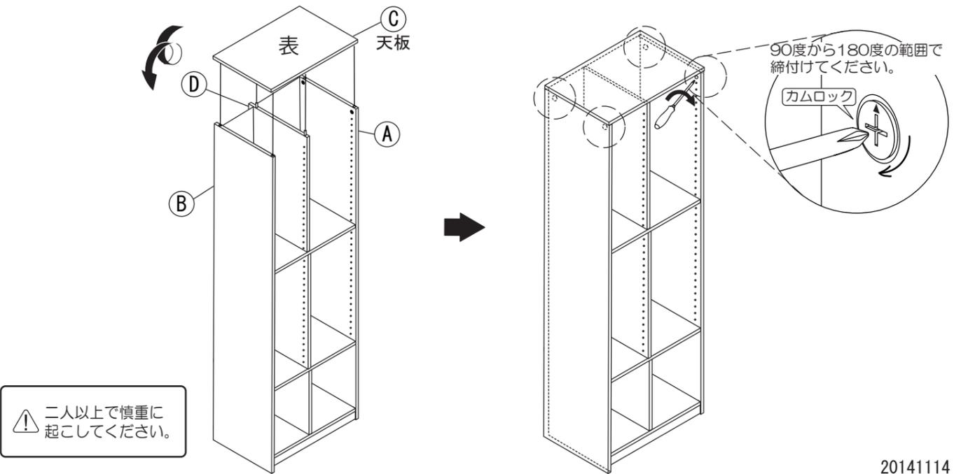
11 ①右側板と②左側板のカムロックに、③カムロックキャップを取り付けてください。
