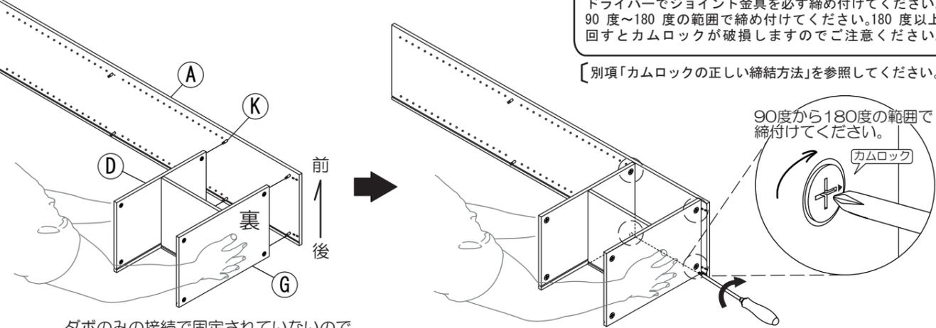
ダボのみの接続で固定されていないので ④ 中板と⑦ 底板を 1人が両手で軽く押さえてください。
