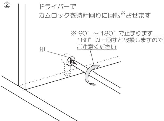
ドライバーでカムロックを時計回りに回転※させます
