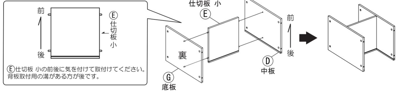
3 2で組み付けた、⑤ 仕切板 小、④ 中板、⑦ 底板の溝に ⑧ 背板 小を差し込んでください。
