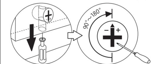
ジョイントシャフトに板を差し込んだら、図のようにドライバーでジョイント金具を必ず締め付けてください。90度～180度の範囲で締め付けてください。180度以上回すとカムロックが破損しますのでご注意ください。
