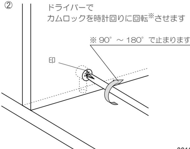
ドライバーでカムロックを時計回りに回転\*させます
