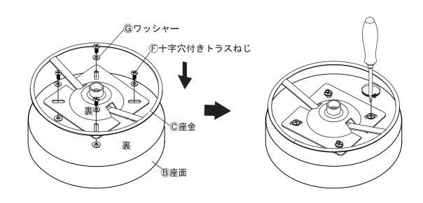
3 で組み付けた©座金の中央の穴に、2 で取り付けたDシリンダーを差し込みます。
