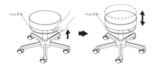
ご使用の前に昇降ハンドルを引き上げて⑩シリンダーが正常に作動することを確認してください。正常に作動しない場合は ⑤シリンダーが⑥座金の奥まで差し込まれていない場合がありますので、⑥座金を差し込み直してください。
