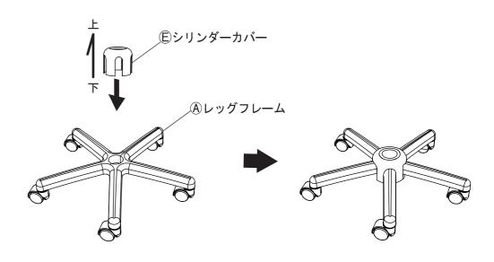
1 で組み付けた®レッグフレームの中央の穴に®シリンダーを差し込みます。
