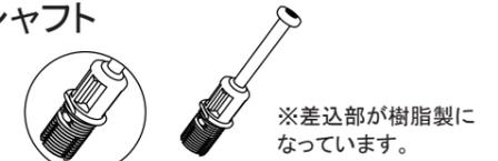
ジョイントシャフトを指定の板面穴に差し込みます。隙間が無いように最後まで差し込んでください。
