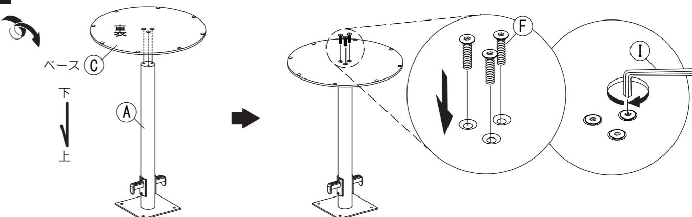
6 ⑧天板に⑤で組んだ脚部を取り付けます。⑩受座と⑧天板の穴位置を合わせ、⑨トラスねじ大で取り付けてください。
