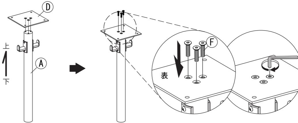
5 ④で組んだ④支柱を逆さまにし、⑥皿ボルトで③ベースを取り付けてください。
