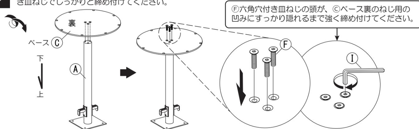
**6** (B)天板に**5**で組み付けた脚部を取り付けます。(D)受座と(B)天板の穴位置を合わせ、**2**で取り外した(G)十字穴付きトラスねじ大でしっかりと締め付けてください。
