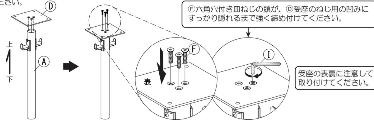
**5** **4**で組み付けた(A)支柱を逆さまにし(C)ベースを組み付けます。(I)六角レンチを使って**1**で取り外した(F)六角穴付き皿ねじでしっかりと締め付けてください。
