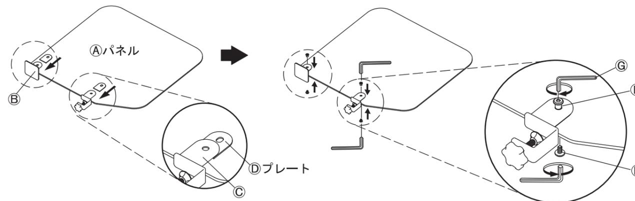
⚠ ④プレートが差し込みにくいことがあります。その場合は無理に差し込まず、プレートは使用せずに⑤六角穴付きJねじと⑥六角穴付きJナットを連結させてください。
