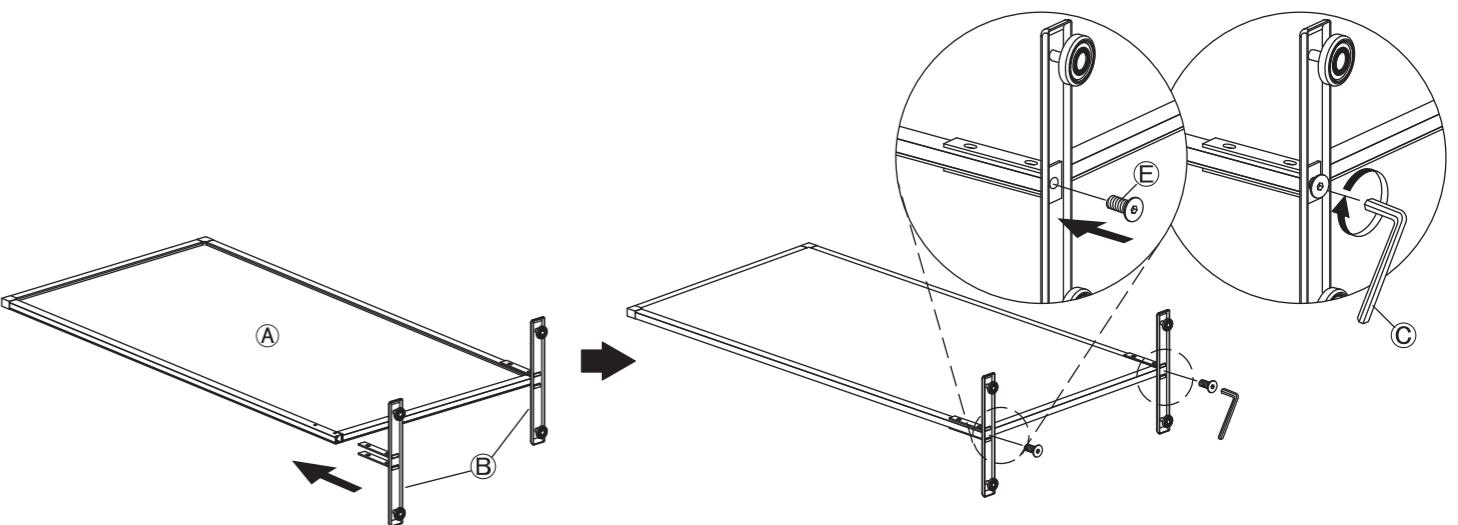
3 図の位置に1で外したⒹ六角穴付き Jボルト・Jナットを取り付けてください。
