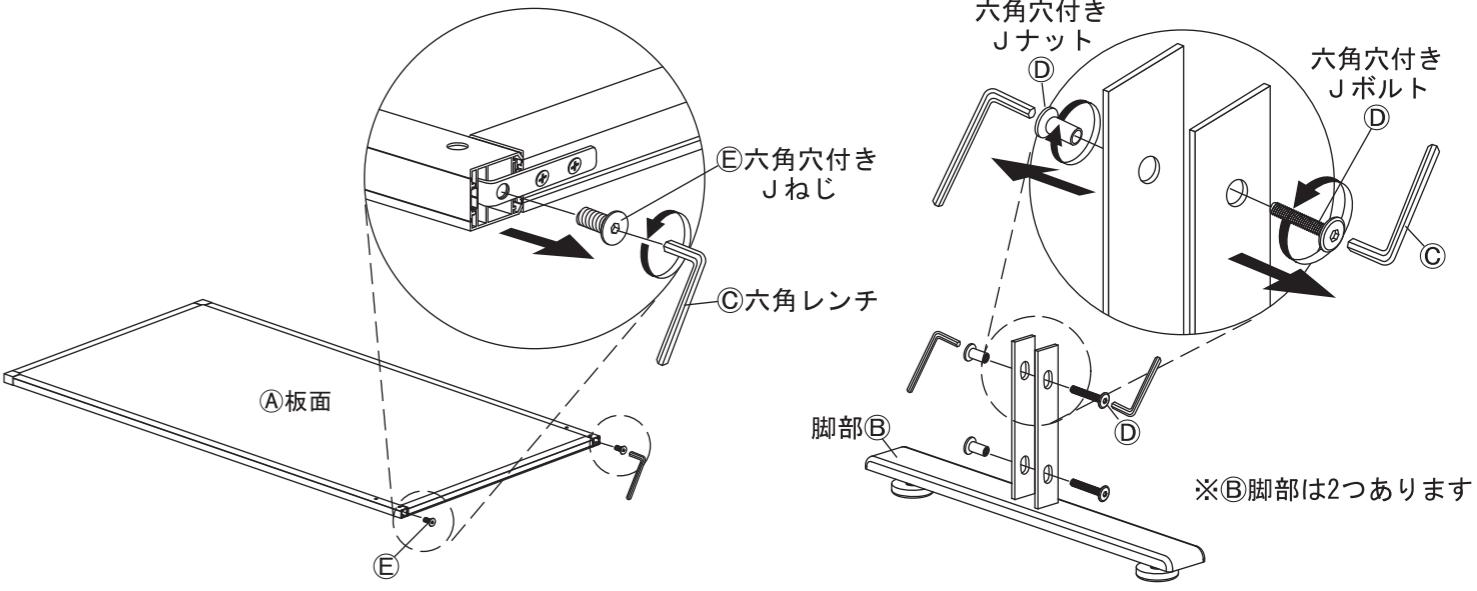
2 Ⓢ板面に1で取り外したⒺ六角穴付き Jねじを使って、Ⓑ脚部を取り付けてください。
