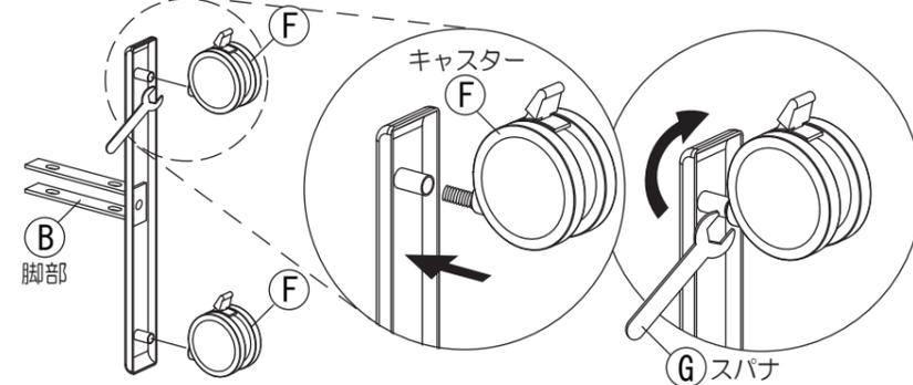
5 4で⑧ キャスターを取り付けた② 脚部を① 板面に差し込みます。その後、1で取り外した③ Jボルトを緩めに回し入れてください。
