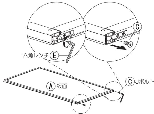
2 ② 脚部に取り付け済みの⑥ 連結ボルト・ナットを⑦ 六角レンチを使って取り外してください。
