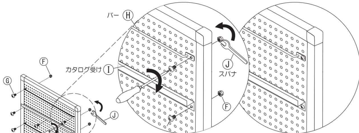
裏から①スパナで⑤袋ナットを押さえ、表からプラスドライバーで⑥十字穴付きトラスねじを締め付けて組み付けてください。
