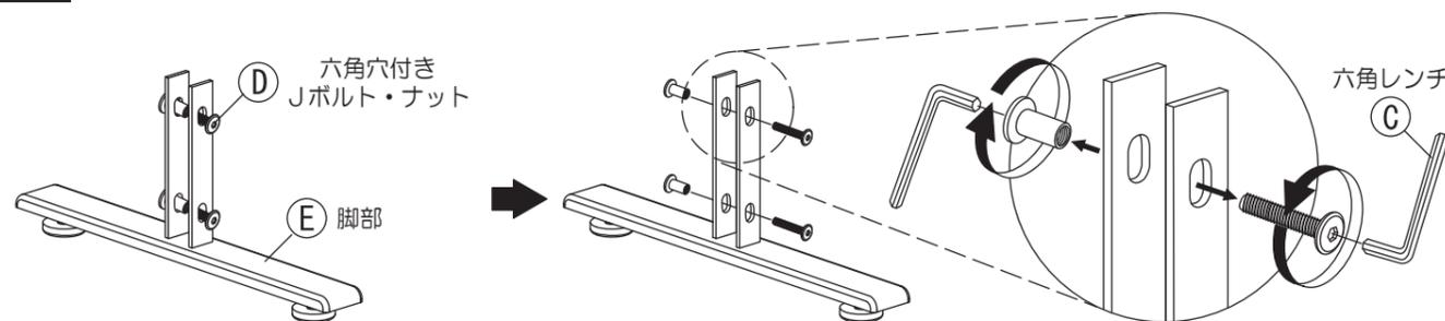
3 ⑤脚部を①板面に差し込みます。その後、1で取り外した②六角穴付きJねじを緩めに回し入れてください。
