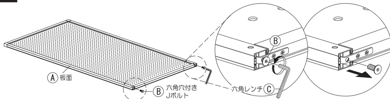
2 ⑤脚部に取り付け済みの④六角穴付きJボルト・ナットを、③六角レンチを使って取り外してください。
