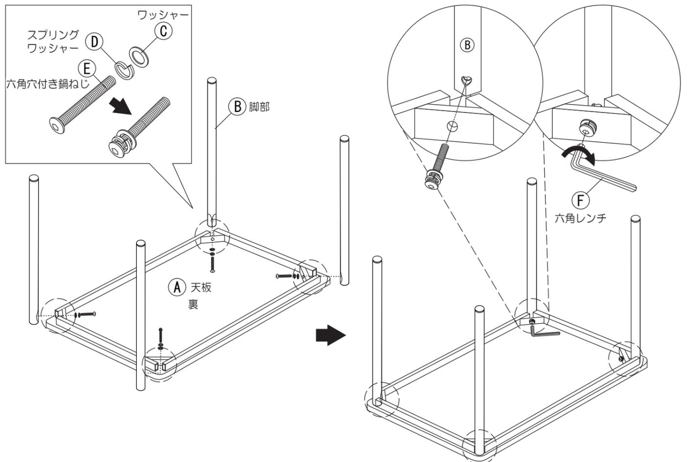
2 ⑥六角穴付き鍋ねじがしっかりと締め付けられていることを確認したら、2人以上で慎重に起こしてください。アジャスターを回し、①天板が床に対して平行になるように調整してください。
