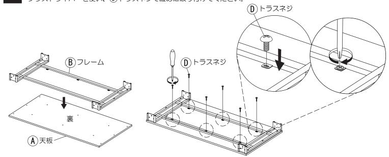
2で組み立てたものをさらにプラスドライバー使って(E)Jネジで緩めに取り付けます。 全てのネジを取り付け終わったら、増し締めし、固定します。
