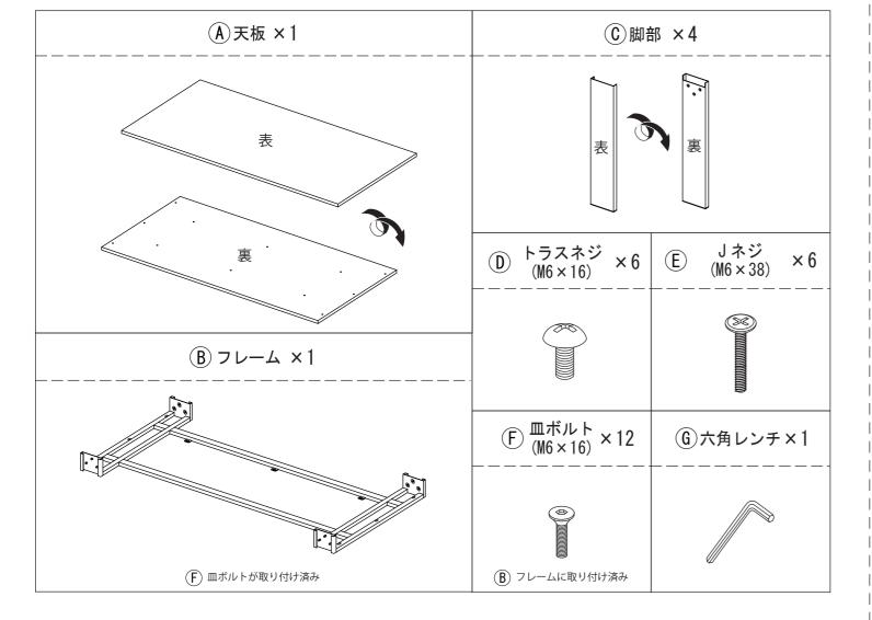
■ Bフレームに取り付け済みの下皿ボルトを⑥六角レンチを使って外します。
