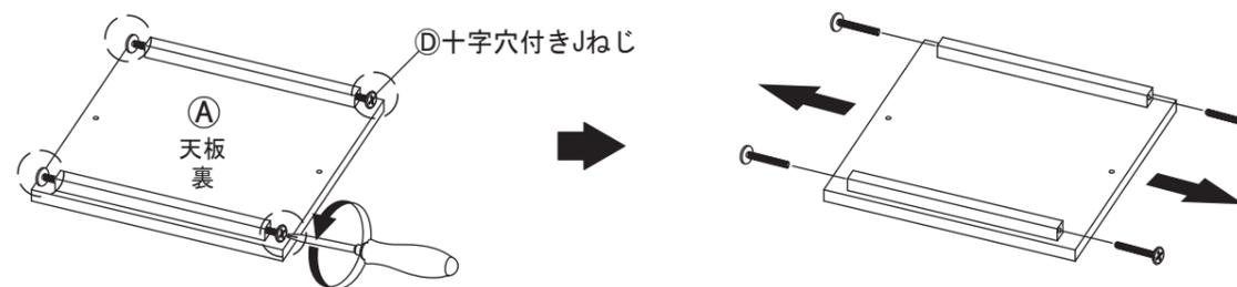
2 ①天板に③脚部を取り付けます。プラスドライバーを使い、④十字穴付きJねじでしっかりと組み付けてください。そして、2人以上で本体を起こしてください。
