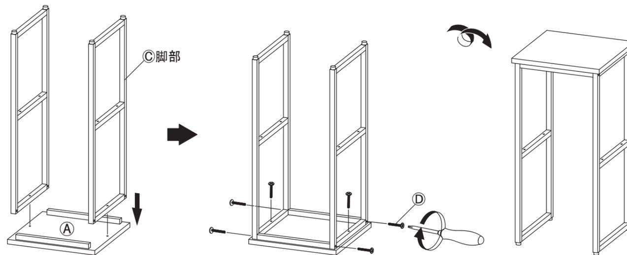
3 ②棚板を③脚部の横から差し込み、③脚部中央のパイプの上に乗せてください。プラスドライバーを使い、②棚板を④十字穴付きJねじでしっかりと固定してください。アジャスターを回して床と①天板が水平になるように調整してください。
