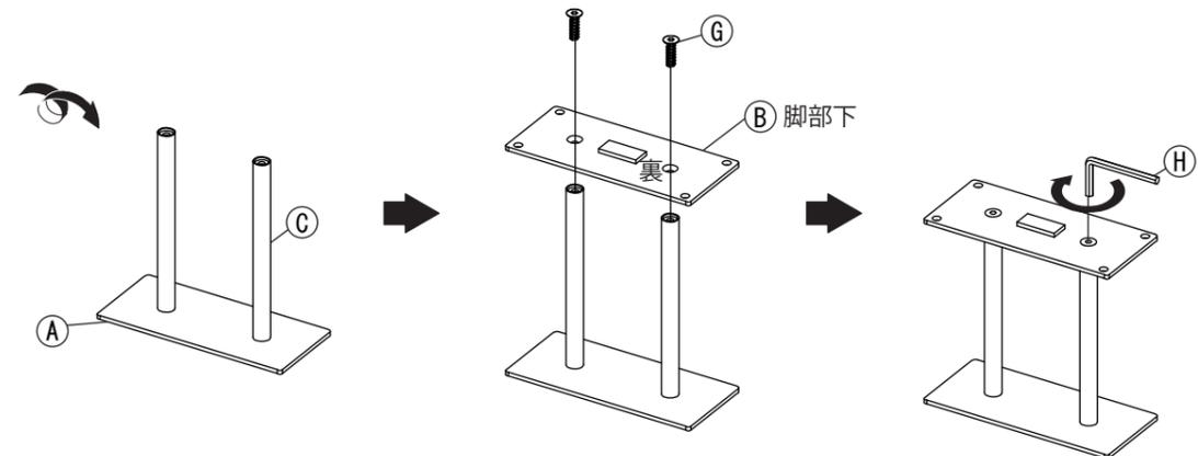
3 ⑤棚板のスチールパーツに④ハンドルを緩めに取り付けます。その後、2で組み付けた脚部をスチールパーツに通し、スムーズに入るか確認します。これで本体は完成です。
