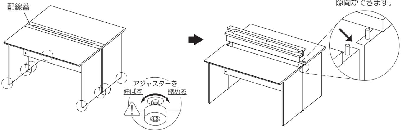
**5** ②で組み立てた脚部をデスクの配線受けに⑥十字穴付きトラスねじで取り付けます。
