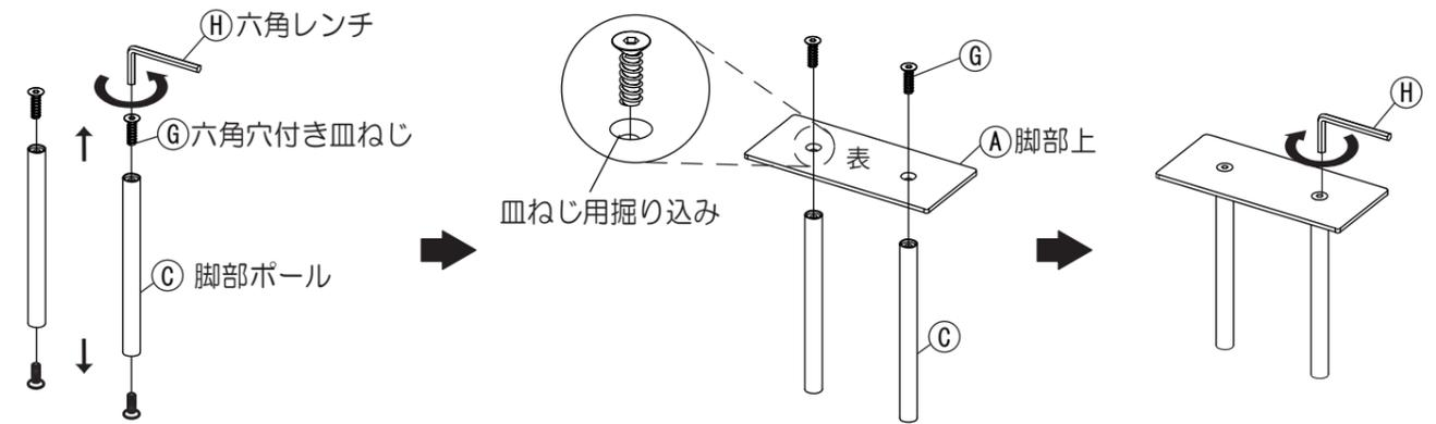
2 逆さにして、③脚部ポールに②脚部下を⑥六角穴付き皿ねじで⑧六角レンチを使って取り付けます。同様に、もう1台脚部を組み立てます。
