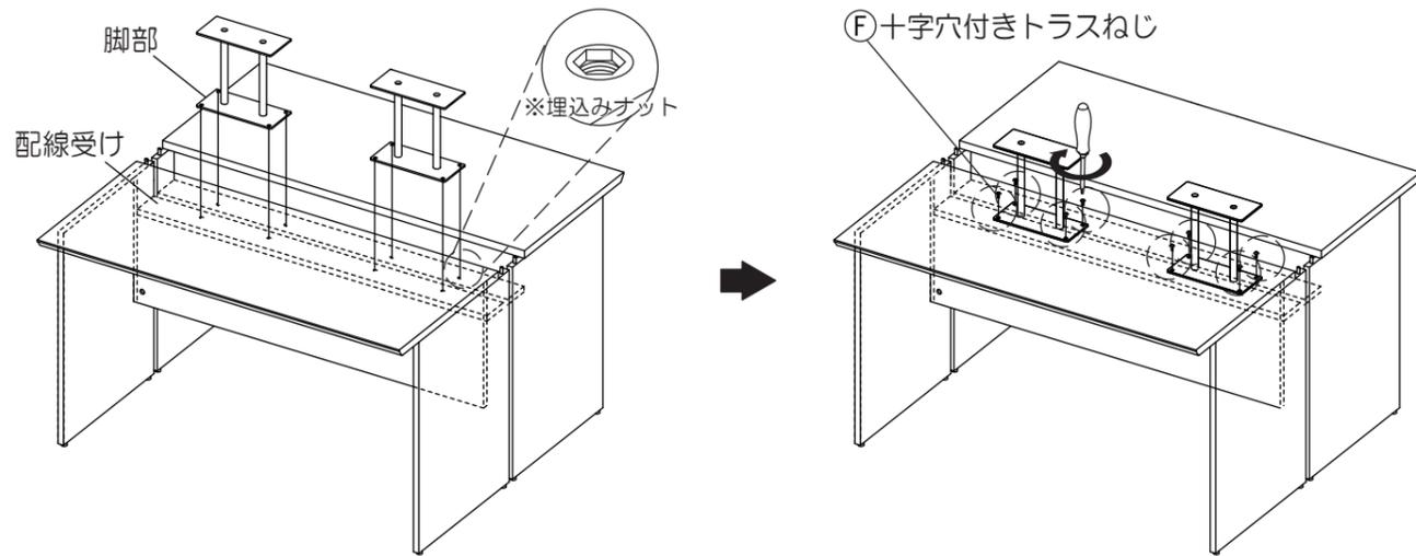
**6** ③で組み立てた⑤棚板を二人以上で慎重に持ち上げ、デスクに取り付けた脚部が⑤棚板の中央にくるようにセットします。
