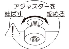
床に接地していないアジャスターを回して水平になるように調整し、がたつかないようにしてください。
