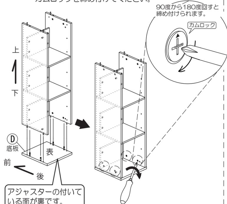
8 同様に③天板を取り付けます。その後、左右側板のカムロックを締め付けてください。
