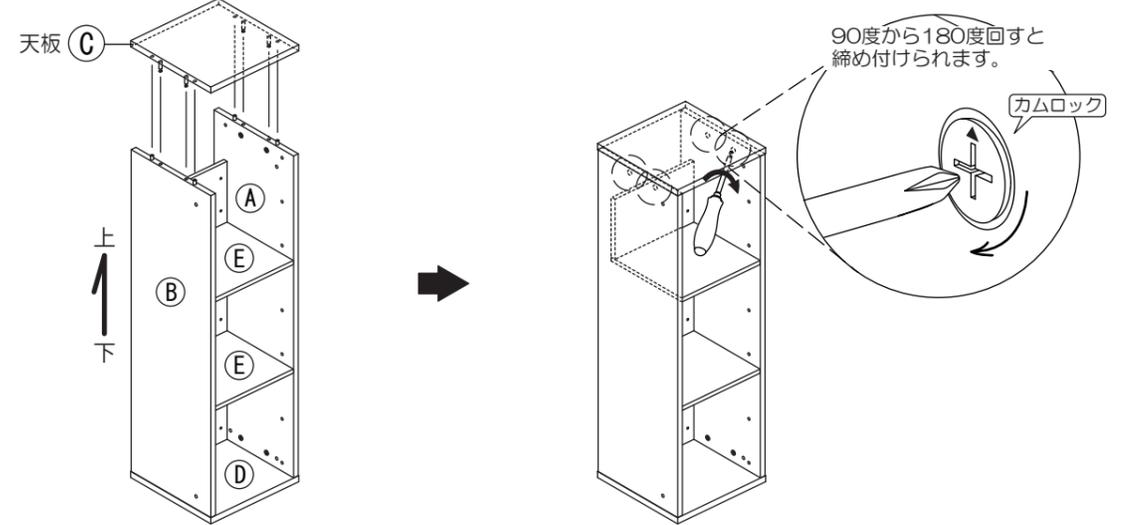
9 全てのカムロックが正常に締結されているか確認した後、図のカムロックに④カムロックキャップを差し込んでください。
