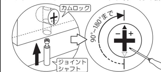
ジョイントシャフトを板の横穴に差し込み、図のようにドライバーでカムロックを締め付けます。この時必ず90度~180度の範囲で締め付けてください。無理に回すと破損の原因となりますのでご注意ください。
