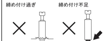
ジョイントシャフトの胴体部分が板面にぴったりと着くまで回し入れてください。それ以上無理な力で締め付けたり、逆に締め付けが不十分だったりすると、破損やがたつきの原因となりますのでご注意ください。
