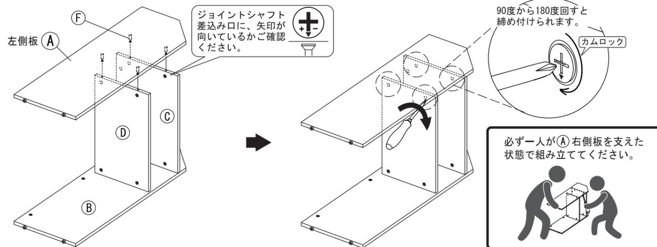
5 ③ 前板の④ 41ジョイントシャフトを④ で組み付けた本体に差し込みます。
