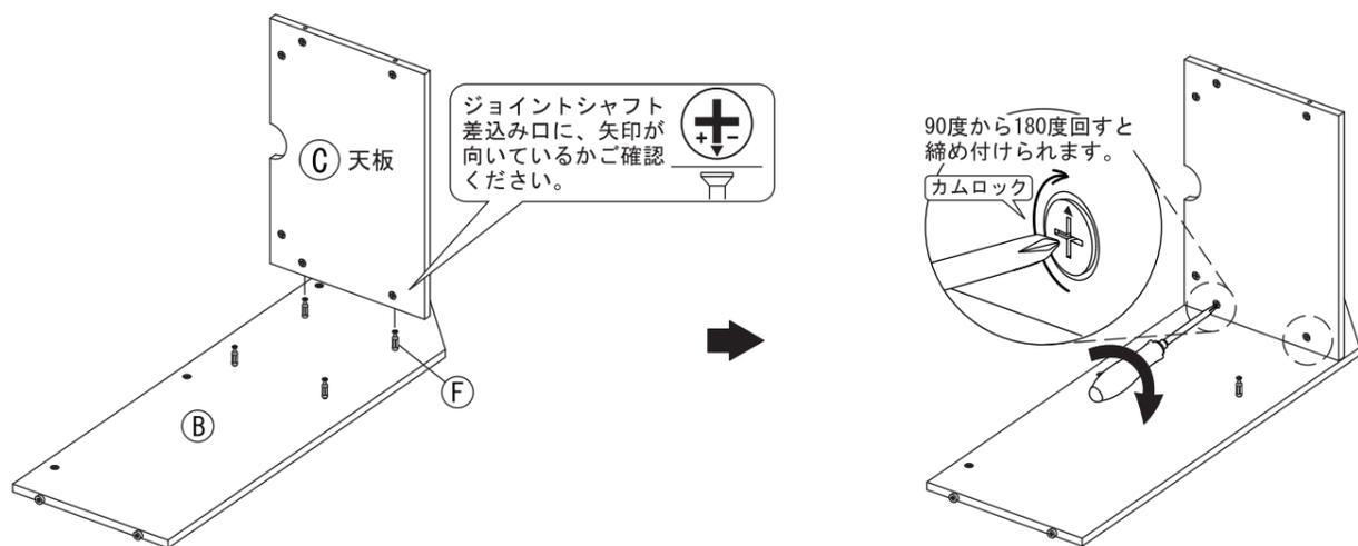
3 ⑦ 右側板の④ 41ジョイントシャフトを⑧ 棚板の横穴に差し込みます。
