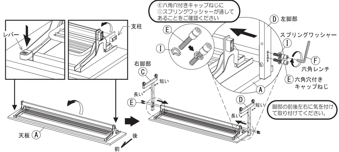
2 図のように③右脚部④左脚部の間に⑤角パイプを取り付けます。⑥六角レンチで②六角穴付きキャップねじを締め付けてください。その後、③右脚部④左脚部の②六角穴付きキャップねじを全て締め付け直してください。
