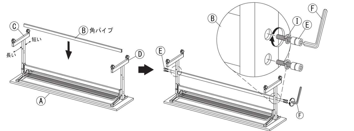
3 2人以上で慎重に本体を起こした後、③右脚部④左脚部に⑧十字穴付きトラスねじで⑨フックを取り付けてください。
