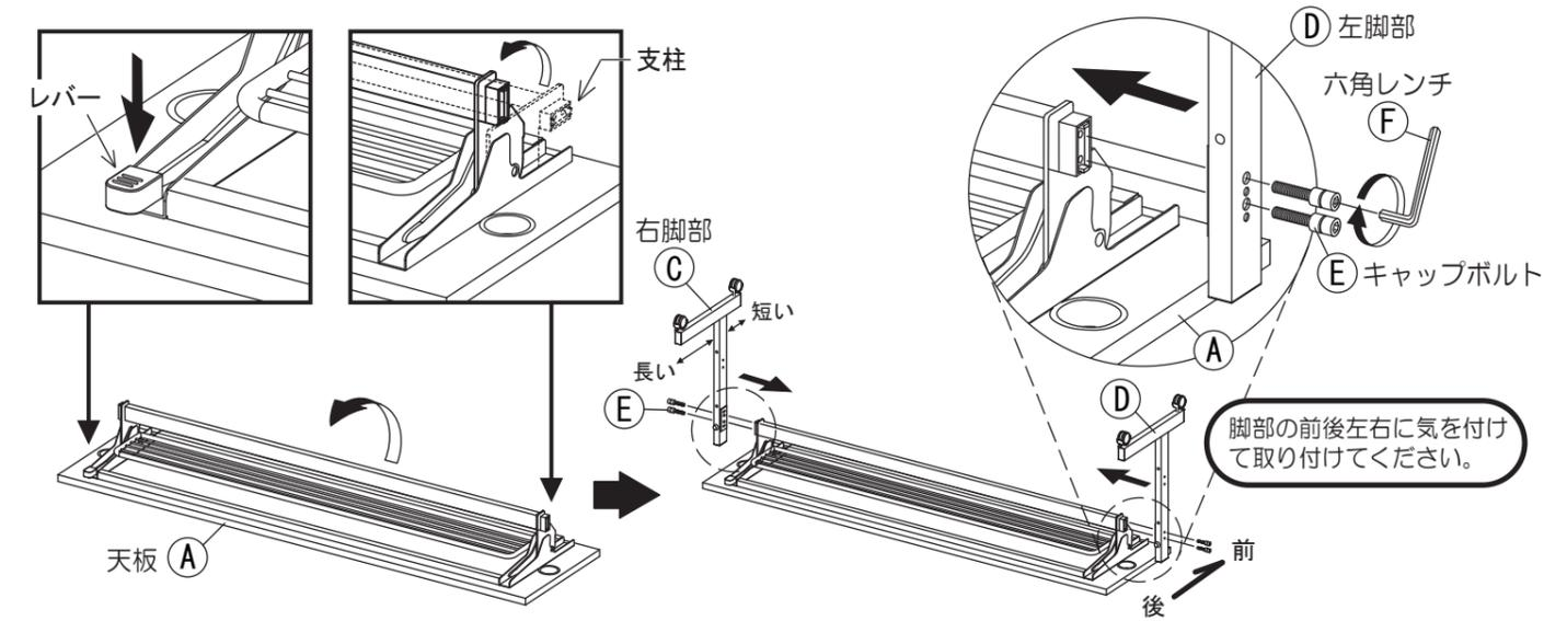
**2** 図のように左右脚部の間に(B)角パイプを取り付けます。(F)六角レンチで(E)キャップボルトを締め付けてください。(E)キャップボルトが取り付けられたら、脚部の(E)キャップボルトを全て締め付け直してください。
