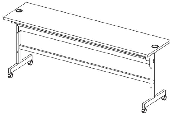
1 ①幕板に②配線レールを取り付けます。プラスドライバーを使い、③小ねじをしっかりと締め付けてください。
