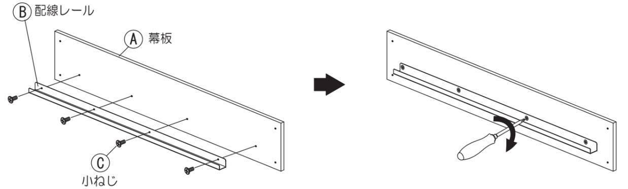
2 ①で組んだ①幕板を脚部に取り付けます。図のようにプラスドライバーを使い、④Jねじをしっかりと締め付けてください。
