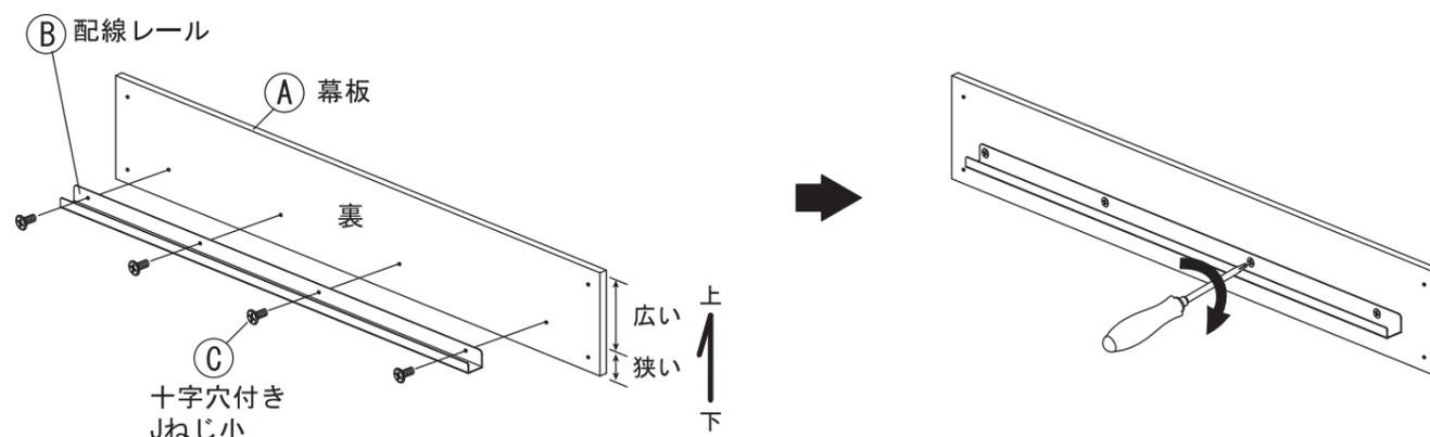
**2** ①幕板を左右脚部に取り付けます。プラスドライバーを使い、④十字穴付きJねじ大でしっかりと締め付けてください。
