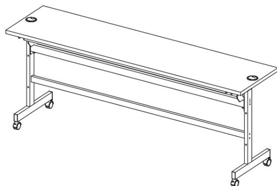
**1** ①幕板に②配線レールを取り付けます。プラスドライバーを使い、③十字穴付きJねじ小をしっかりと締め付けてください。
