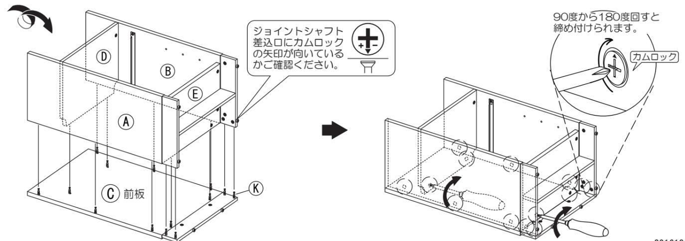
7 ①荷物台の①ジョイントシャフトを①受け板に差し込みます。その後、①受け板のカムロックを締め付けてください。
