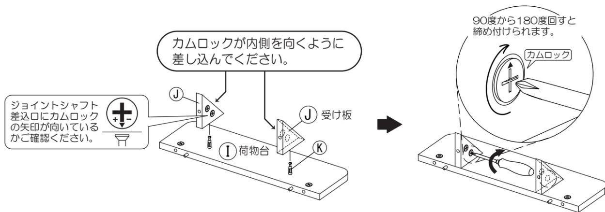
8 2人以上で慎重に本体を起こしてください。③前板の表面に①ジョイントシャフトを回し入れ、⑦で組んだ①荷物台を差し込みます。その後、①荷物台・①受け板のカムロックを締め付けてください。
