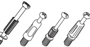
ジョイントシャフトを板面の埋め込み(鬼目)ナットに回し入れます。手で回し入れたあと、プラスドライバーを使用して90度ほど増し締めしてください。
