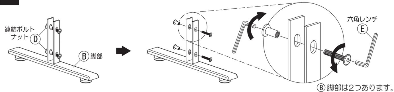
3 ②脚部を①板面に差し込みます。その後、1で取り外した③Jボルトを緩めに回し入れてください。
