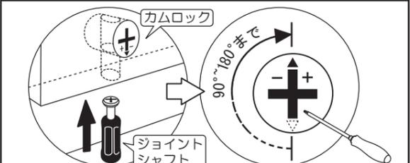
ジョイントシャフトを板の横穴に差し込み、図のようにドライバーでカムロックを締め付けます。この時必ず90度~180度の範囲で締め付けてください。無理に回すと破損の原因となりますのでご注意ください。
