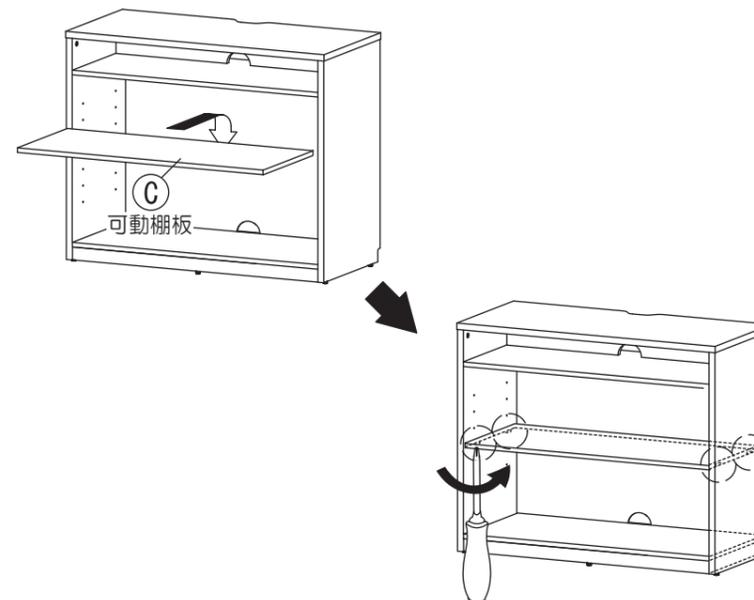
12 (C)可動棚板の(P)ジョイントシャフトに(N)補強板を差し込みます。その後、(N)補強板のカムロックを締め付けてください。
