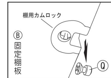
② 図のようにプラスドライバーを差し込み、90度~180度の範囲で締め付けてください。
