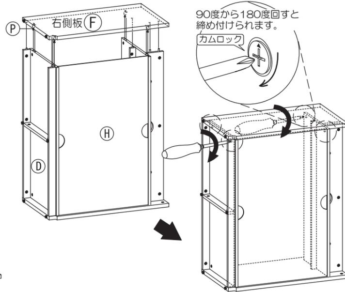
11 (H)背板(下)と左右側板・棚板のすき間に(S)背板止めを差し込みます。プラスドライバーを使い、(U)木ねじ小で固定してください。
