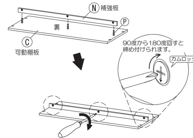
〈固定棚板の締め付け方法〉
