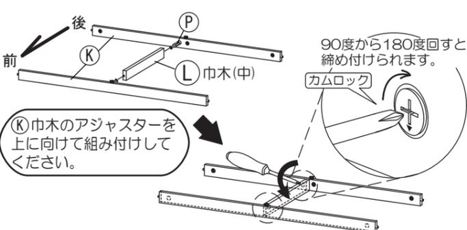
**5** 4で組み付けた巾木を(D)底板の(P)ジョイントシャフトに差し込みます。その後、(K)巾木(前後)のカムロックを締め付けてください。
