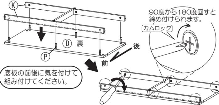
6 (E)左側板の(P)ジョイントシャフトに(3)で組んだ(B)固定棚板を差し込んでください。その後、(B)固定棚板のカムロックを締め付けてください。
