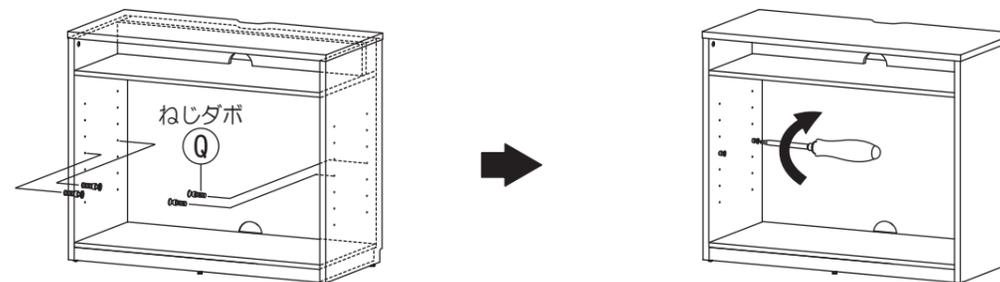
14 (12)で組んだ(C)可動棚板を(Q)ねじダボとかみ合うようにのせてください。その後、「固定金具の締め付け方法」を参考に、(C)可動棚板の棚用カムロックを締め付けてください。
