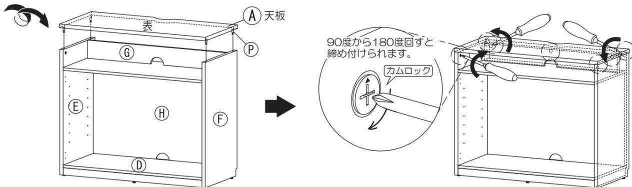
7 同様に、(D)底板を(E)左側板の(P)ジョイントシャフトに差し込んでください。その後、(D)底板のカムロックを締め付けてください。
