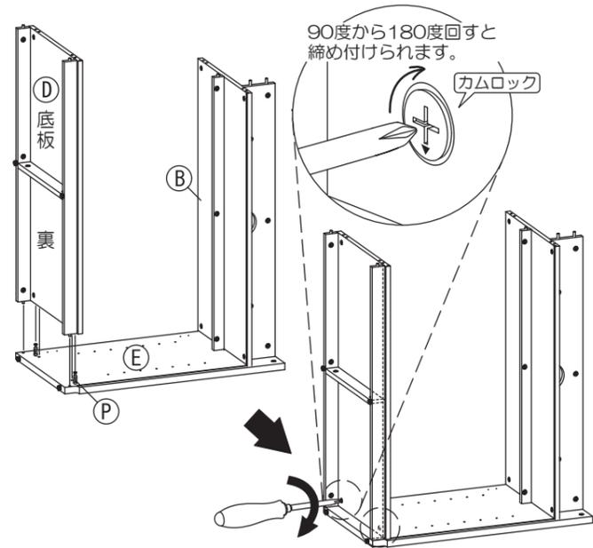
9 (8)で組み付けた本体に(F)右側板の(P)ジョイントシャフトを差し込んでください。その後、(F)右側板のカムロックを締め付けてください。
