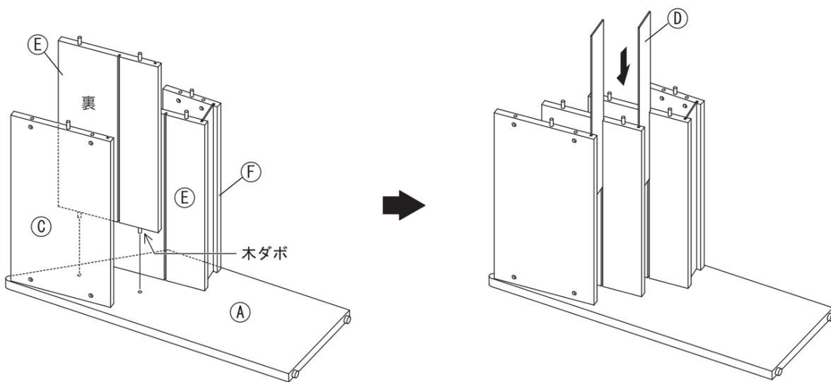
5 (C) 棚板1・(E) 棚板2・(F) 棚板3の木ダボを(A) 左側板に差し込みます。
