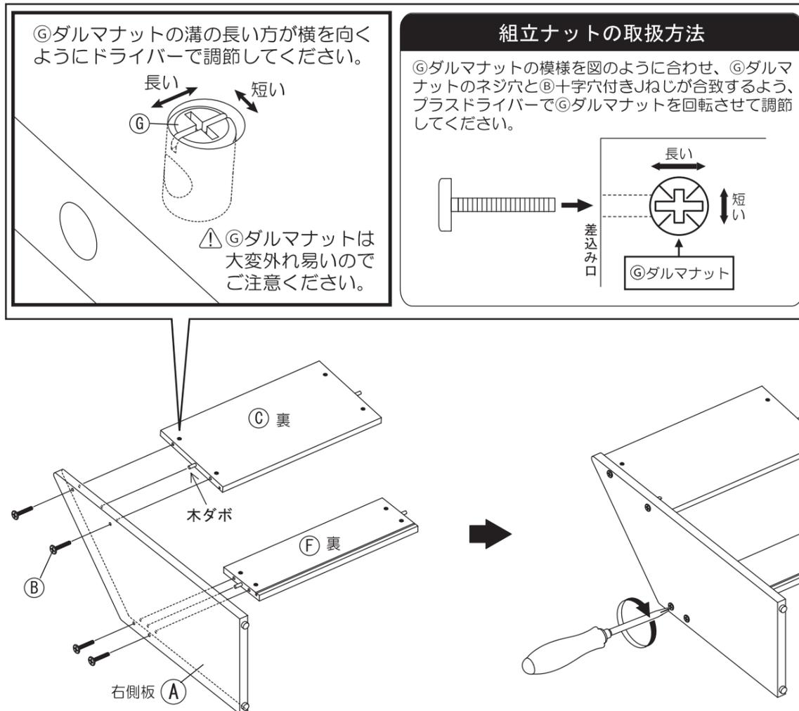
3 図のように倒し、(A) 右側板に(E) 棚板2の木ダボを差し込んでください。
