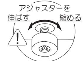
床に接地していないアジャスターを回して水平になるように調整し、がたつかないようにしてください。
