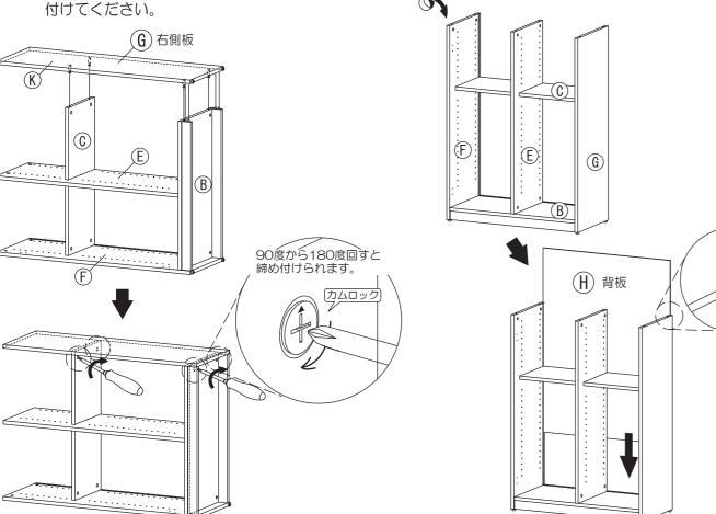
④天板の⑥ジョイントシャフトを序左側板・⑥仕切板・⑥右側板の横穴に差し込んでください。 その後、序左側板・⑥仕切板・⑥右側板のカムロックを締め付けてください。
