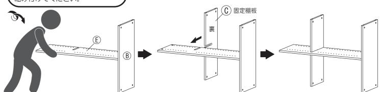
3 で組んだ本体に下左側板を取り付けます。下 左側板の €ジョイントシャフトを ® 底板・ © 固定棚板の 横穴に差し込んでください。C 固定棚板が外れ易くなっておりますのでご注意ください。
