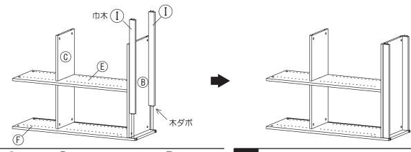
⑥右側板の (K)ジョイントシャフトを (C) 固定棚板・ (B) 底板の横穴に差し込んでください。 その後、© 固定棚板・B 底板のカムロックを締め
