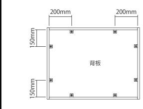
天板・底板側は1つ外側から約150mmの位置に、 左側板・右側板には2つを角から約200mmの 位置にそれぞれ取り付けてください。
