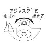
床に接地していないアジャスター を回して水平になるように調整し、 がたつかないようにしてください。 カムロックの正しい締結方法
