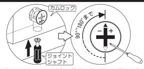
ジョイントシャフトを板の横穴に差し込み、図のよう にドライバーでカムロックを締め付けます。この時必 ず90度~180度の範囲で締め付けてください。無理に回 すと破損の原因となりますのでご注意ください。
