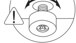
床に接地していないアジャスターを回して水平になるように調整し、がたつかないようにしてください。
